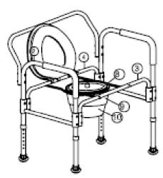
Поставьте насадку на ведро  $(8 \times 1)$ , ведро  $(9 \times 1)$  и защиту от брызг  $(10 \times 1)$  в отверстие, закрепленное на трубках кронштейнах.
