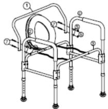
Установите  $(1 \times 1)$  спинку в отверстие между подлокотниками  $(2 \times 2)$  Закрепите шурупами  $(7 \times 4)$  болтами  $(5 \times 4)$  контрагайками  $(6 \times 4)$
