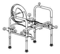
Установите трубку-кронштейн между подлокотниками (2 x 2) Закрепите шурупами (4 x 8) болтами (5 x 8) контргайками (6 x 8)
